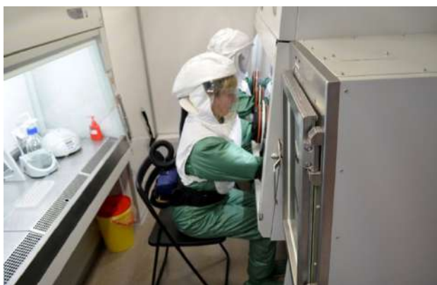
Рис. 1.8. Работа в боксе микробиологической безопасности III класса защиты в лаборатории индикации МК СПЭБ
